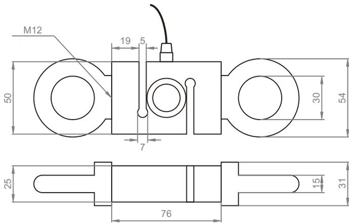
图5 传感器外形及安装尺寸图
